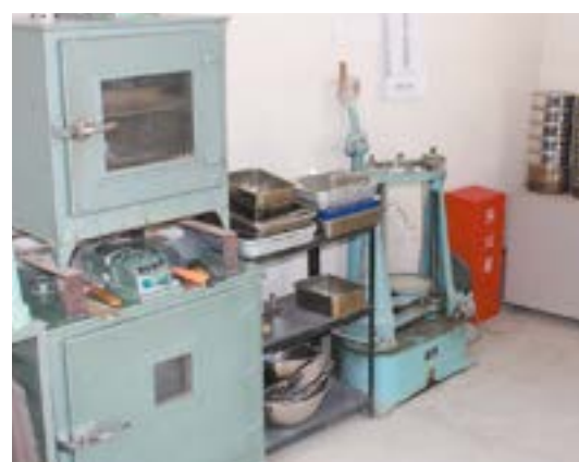
試験室内部 骨材粒度分布を調査する、ふるいわけ試験は製品ごとに行い、試験データが生産工程に役立ち、お客様に信頼される品質管理を行っています。
