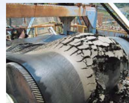
サンドクリーン コンクリートの強度に影響を及ぼす泥分や微粒物を洗い落とし、砂を生産しています。
