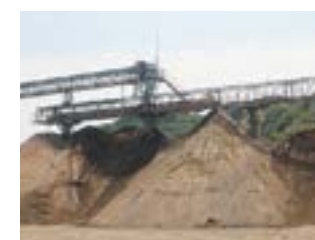
砂生産・ストック場 サイズごとに洗浄・選別された製品はベルトコンベアで運ばれ、ストックしています。
